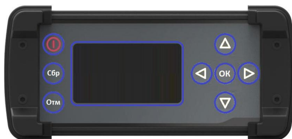
Внешний вид Приемника ГНСС Р90
